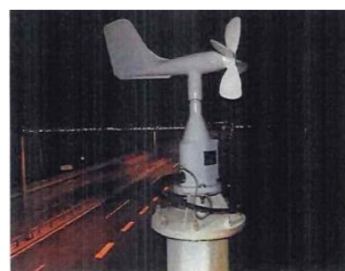
連絡橋風速計更新
