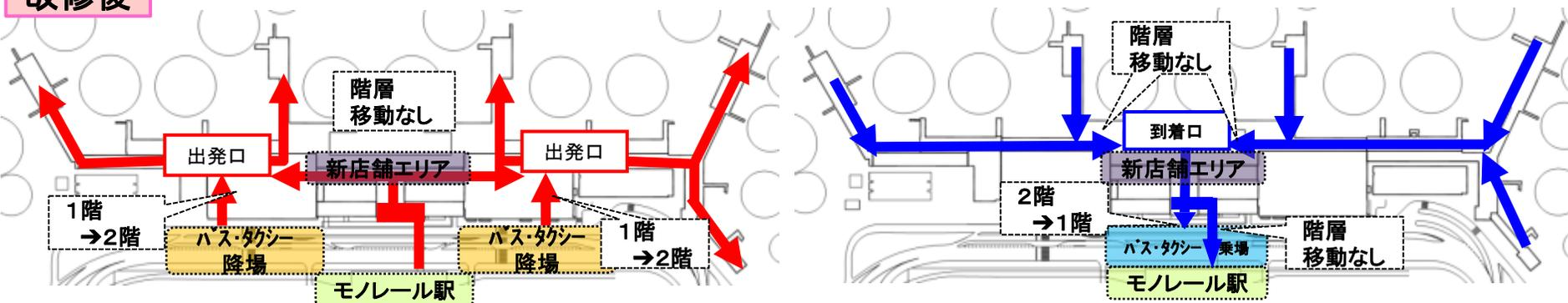
モノレール駅とターミナルビル中央2階が直結。また、バス降場を南北ビル前へ配置することにより、出発時の乗継ぎ動線を短縮。
